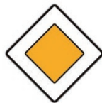
Hlavní pozemní komunikace
